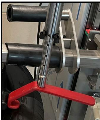
**FASE 20** SOLLEVARE IL SELETTORE VERTICALE DELL'UTENSILE FINO A QUANDO IL BRACCIO DELLA TESTA DI (DE)MONTAGGIO PUÒ MUOVERSI LIBERAMENTE SUL PNEUMATICO. PORTARE IL BRACCIO IN POSIZIONE DI BLOCCO.
