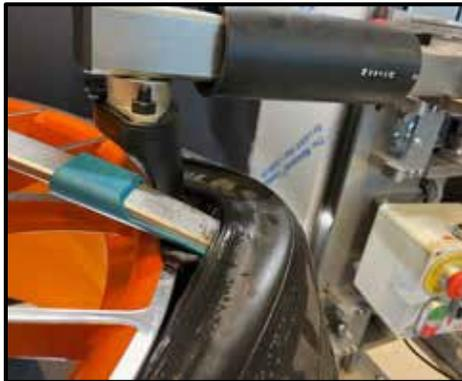
**FASE 17** ORA FATE GIRARE IL MONTANTE CENTRALE IN SENSO ORARIO PER RIMUOVERE IL TALLONE SUPERIORE DAL CERCHIO. ASSICURARSI CHE IL COPERCHIO DELLA LEVA DEL PNEUMATICO SIA IN BUONE CONDIZIONI PER EVITARE L'ATTRITO METALLO-METALLO DURANTE LA ROTAZIONE. (IL COPERCHIO DELLA LEVA DEL PNEUMATICO È UN PEZZO DI RICAMBIO CONSUMABILE)
