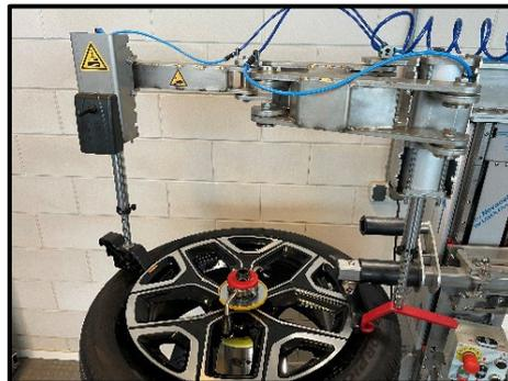
**FASE 24** ABBASSARE IL GANCIO, AZIONANDO IL CILINDRO PNEUMATICO, FINO AD AFFERRARE IL TALLONE DEL PNEUMATICO. DURANTE IL PROCESSO (SIA VERSO L'ALTO CHE VERSO IL BASSO) È FONDAMENTALE GUIDARE IL GANCIO TENENDO LA PRESA.
