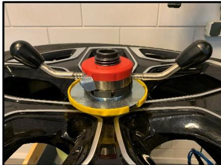
**FASE 4** SVITARE IL DADO RAPIDO E RIMUOVERE LA COPERTURA IN PLASTICA DEL CONO CHE TIENE I DOPPI CONI METALLICI.
