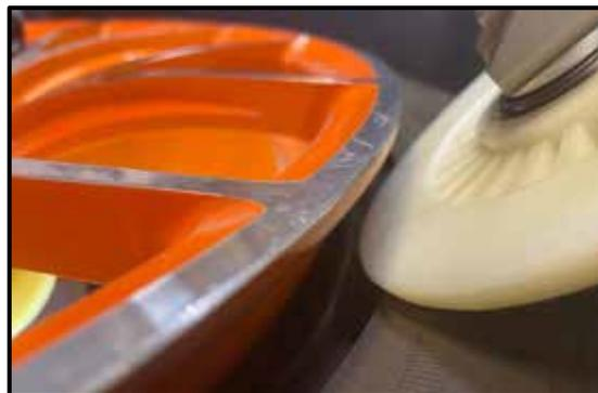
**FASE 12** DOPO AVER COMPLETATO IL PROCESSO DI STALLONATURA, PREMERE IL PULSANTE "SU". IL MONTANTE CENTRALE TORNA ALLA POSIZIONE DI PARTENZA.
