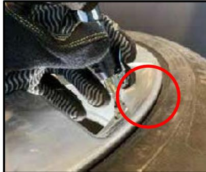
**FASE 2** **PER RISPARMIARE TEMPO SI CONSIGLIA DI INIZIARE CON IL TALLONE INFERIORE.** ABBASSARE IL SELETTORE VERTICALE DEGLI UTENSILI FINO A QUANDO IL BRACCIO DEL TALLONE INFERIORE CON IL DISCO PUÒ MUOVERSI LIBERAMENTE SOTTO IL PNEUMATICO. PORTARE IL BRACCIO IN POSIZIONE DI BLOCCO.
