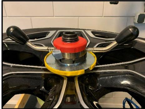
**FASE 7** I BRACCI DEL DADO RAPIDO POSSONO ORA ESSERE RIPIEGATI PER RIDURRE AL MINIMO L'INTERFERENZA QUANDO SI USA LA LEVA PER LO SMONTAGGIO DEL PNEUMATICO.
