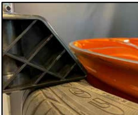
**FASE 16** POSIZIONARE LA LEVA DEL PNEUMATICO SULLA TESTA DI (DE)MONTAGGIO, SOLLEVARE IL TALLONE E TIRARLO SOPRA LA TESTA DI (DE)MONTAGGIO.
