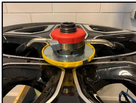
**FASE 8** **IMPOSTARE LA POSIZIONE DI PARTENZA DELLA MACCHINA** CONTROLLANDO LA MISURA DEL PNEUMATICO. QUINDI SPOSTARE LA TAVOLA SULLA MISURA GIUSTA DEL PNEUMATICO CON L'AIUTO DEL RIGHELLO E DELL'INDICATORE. SOLO INDICAZIONE, POTREBBE ESSERE NECESSARIA UNA REGOLAZIONE FINE.
