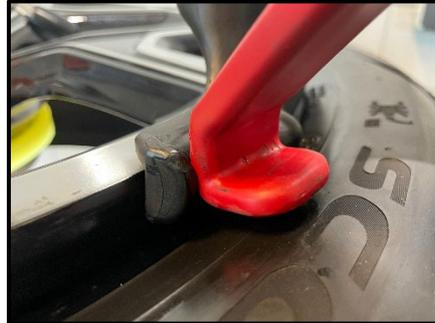
**FASE 23** A SECONDA DELLA COMPLESSITÀ DEL PNEUMATICO, UTILIZZARE IL BRACCIO AUSILIARIO (2) E IL RELATIVO BLOCCO DI PRESSATURA PER PREMERE DELICATAMENTE IL TALLONE DEL PNEUMATICO SUL LATO OPPOSTO. QUESTO PER ASSICURARSI CHE IL TALLONE SI TROVI AL CENTRO DELLA GOCCIA PER GARANTIRE UNO SPAZIO SUFFICIENTE DURANTE LO SMONTAGGIO CON IL GANCIO DI CONTROLLO E LA TESTA DI (SMONTAGGIO). LO SPRAY PER PNEUMATICI ELUBE SVOLGE UN RUOLO FONDAMENTALE DURANTE IL MONTAGGIO E LO SMONTAGGIO.
